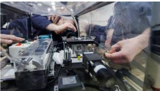
**Figura 3.** Los investigadores de FLUTE capturan datos mientras empujan aceite sintético en un marco circular (aproximadamente del tamaño de una moneda de un dólar), formando momentáneamente una lente líquida durante un período de
