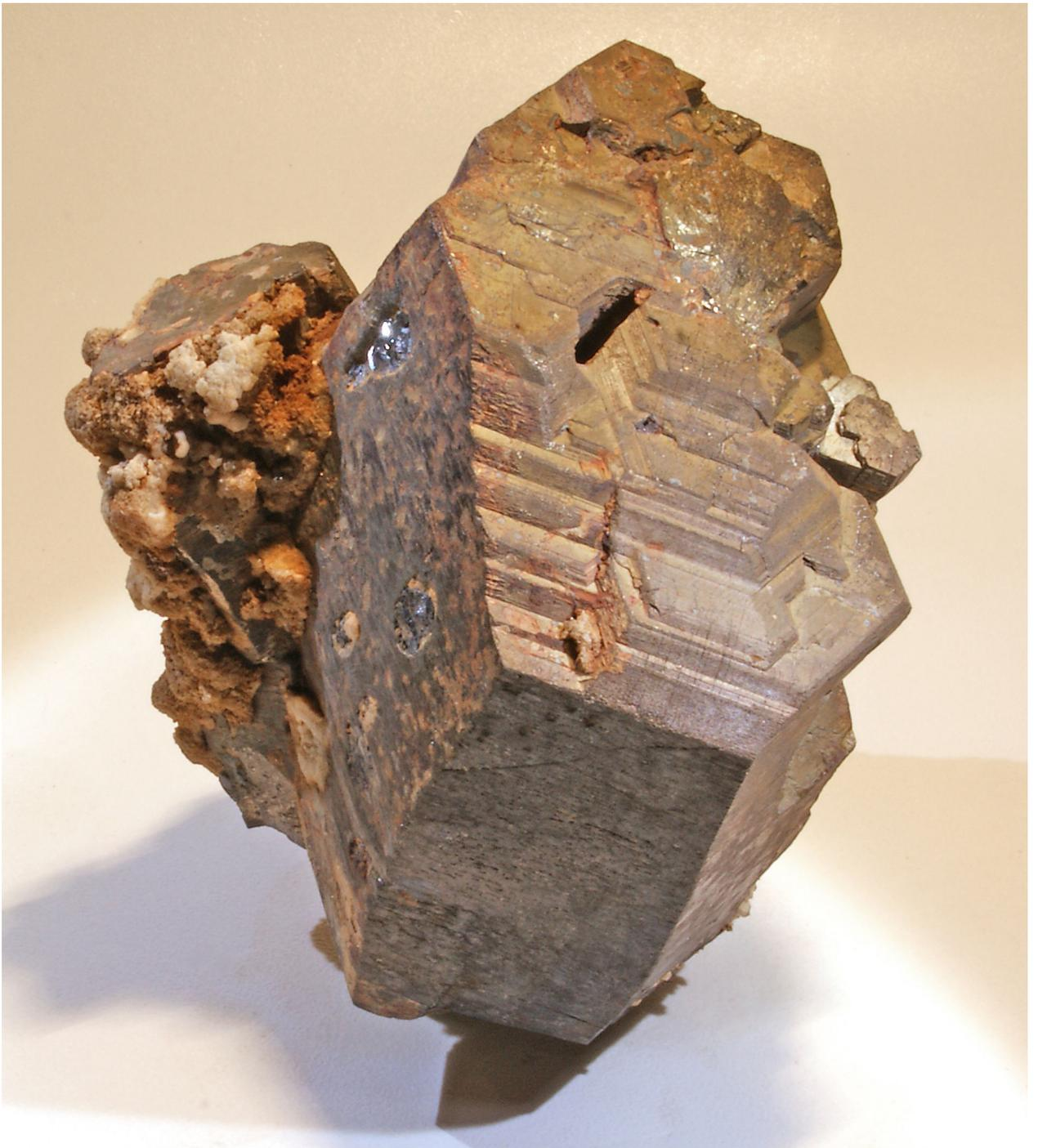
**Figura 2.** Pirrotita, ejemplo de compuesto inorgánico no estequiométrico, de fórmula  $S$  ( $x = 0$  a  $0,2$ ).
