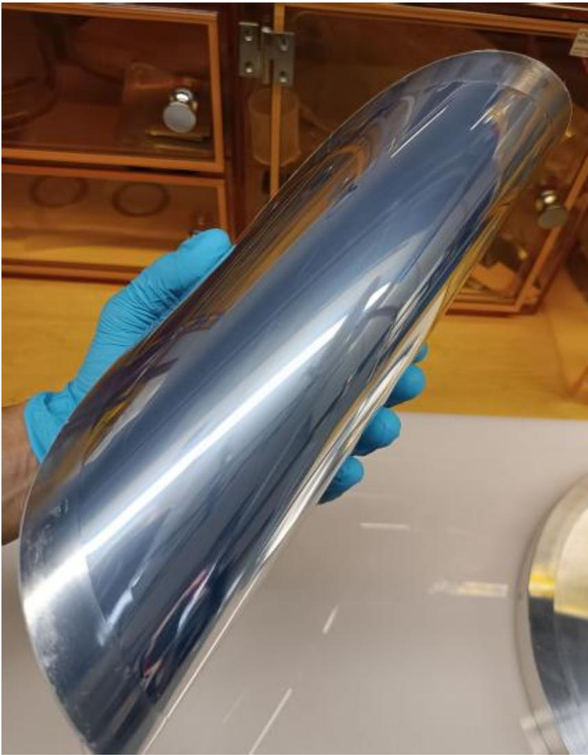
**Figura 3.** Los espejos de membrana hechos con la nueva técnica son lo suficientemente flexibles como para enrollarse. Esto podría ser útil para almacenar los espejos dentro de un vehículo de lanzamiento. Crédito: Sebastian Rabien, Instituto Max Planck de Física Extraterrestre.
