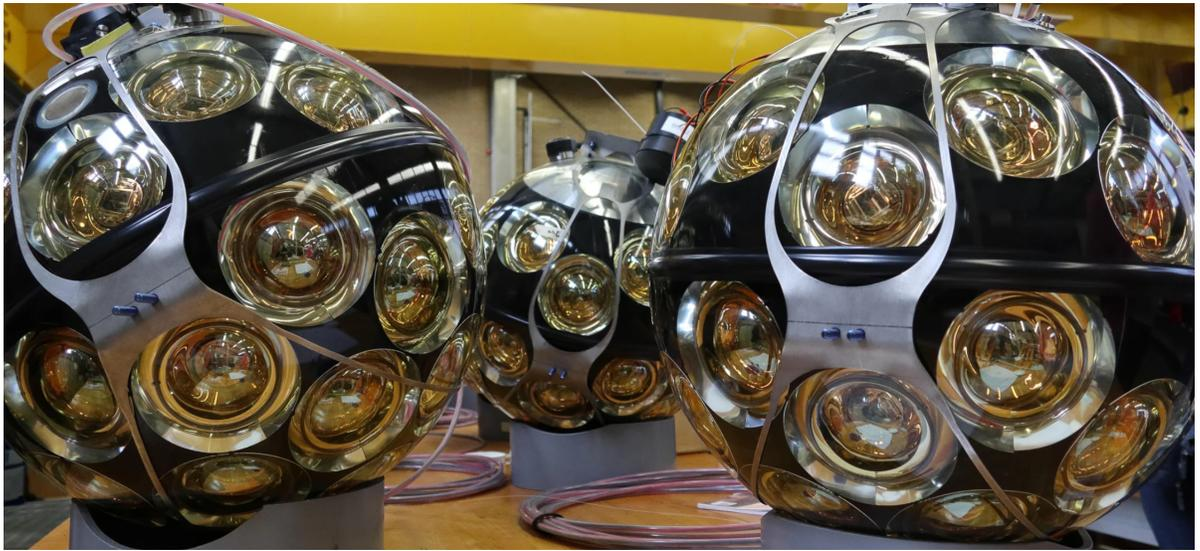
Figura 2: Tres Módulos Ópticos Digitales KM3NeT (DOM). Cada módulo consta de dos esferas de la mitad de vidrio llenas de toda la electrónica necesaria, energía y 31 tubos fotomultiplicadores sensibles a la luz (PMTs). Fuente: Durk Gardenier/Alamy Stock Photo.
